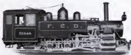
COMBINATION RACK AND ADHESION LOCOMOTIVE
